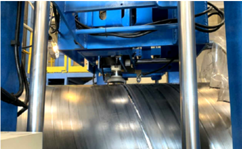
Weld Bead 제거 장비(State Pipe & Supply)
