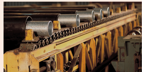
단열이중관 발포(폴리우레탄 폼 충전작업) 작업대
